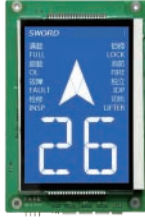
Model/型号：FHS0BW06-0(1.0) Dimension/尺寸：173*126*15.6
